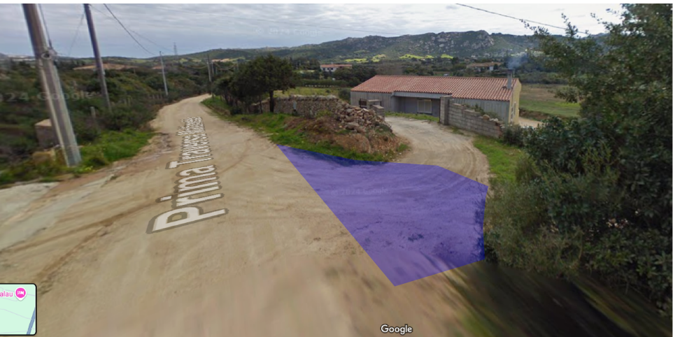
Particolare raccordo in in cls (h cm 10) da realizzare per accesso in pendenza (al fine di preservare la nuova pavimentazione in inerte stabilizzato)
