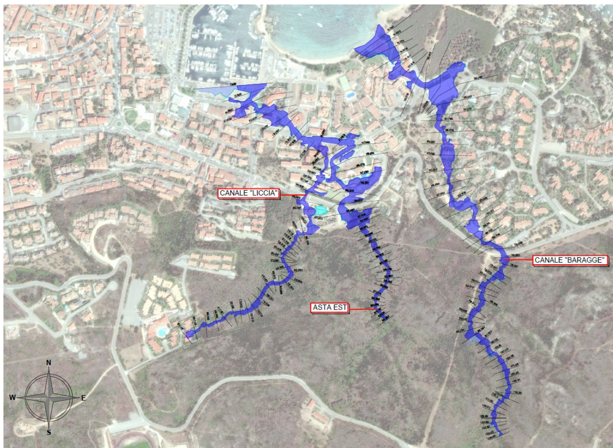
Figura 16. Aree di pericolosità idraulica – Condizione Ante operam
