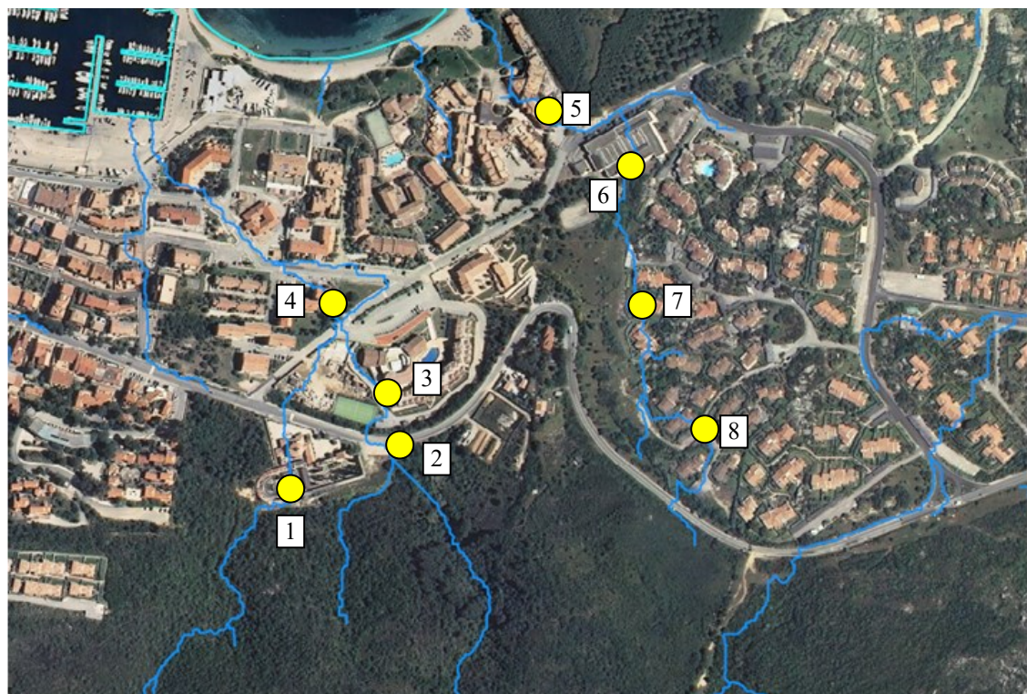
Figura 13 - individuazione punti critici soggetti ad allagamenti lungo il Canale Licia e Canale Baragge
