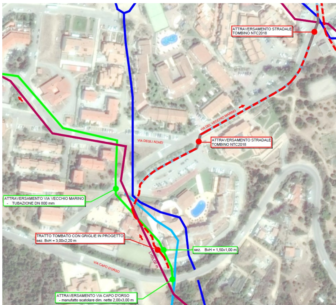
Figura 8 - planimetria di dettaglio con tracciati del reticolo ufficiale, dei canali tombati esistenti e delle opere in progetto (in rosso)
