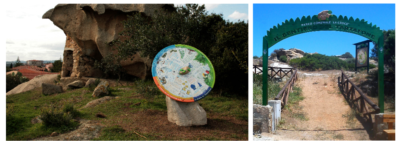
Pannello rotante da ripristinare: si rimuoverà il sostegno in vetroresina e si monterà su palo
