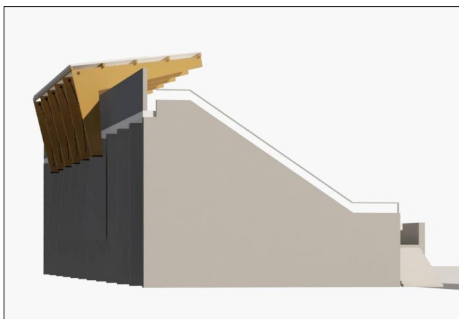
Fig.14 Schema di affiancamento dei pilastri di supporto della pensilina al corpo di fabbrica della tribuna
